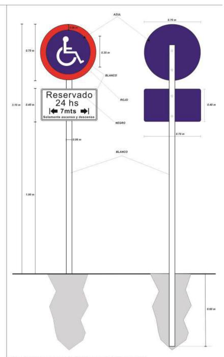
Placa de hierro galvanizado Nº 14 de 0.70 m de diámetro; Placa de hierro galvanizado Nº 14 de 0.30 m x 0.70 m; Caño de hierro galvanizado de 63 mm. diametro y 3 mm de espesor de 3.70 m de altura. Las señales deberán ser confeccionadas en material reflectivo.
